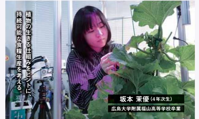
私たちの研究室では、植物の光合成に着目し、作物の生産性向上を目指しています。私は、次世代スマート農業に向けた植物用ウェアラブルセンサを開発しています。それを用いて光合成や蒸散を可視化し、作物の栽培管理や栽培環境を最適化するのが目標です。実際の農業生産者からセンサ開発に対する要望や期待の声を頂いたときに、研究のやりがいを感じます。
