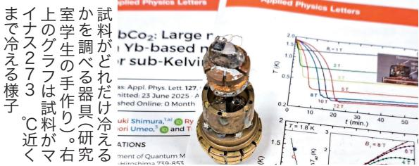
試料がどれだけ冷えるかを調べる器具(研究室学生の手作り)。右上のグラフは試料がマイナス273°C近くまで冷える様子
