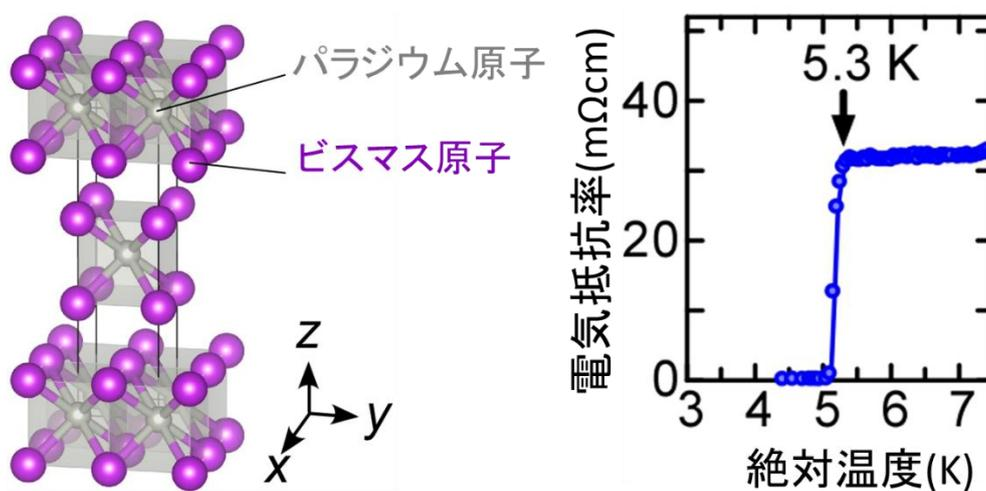
図 1 パラジウムビスマス超伝導体 PdBi<sub>2</sub> の結晶構造と電気抵抗率
