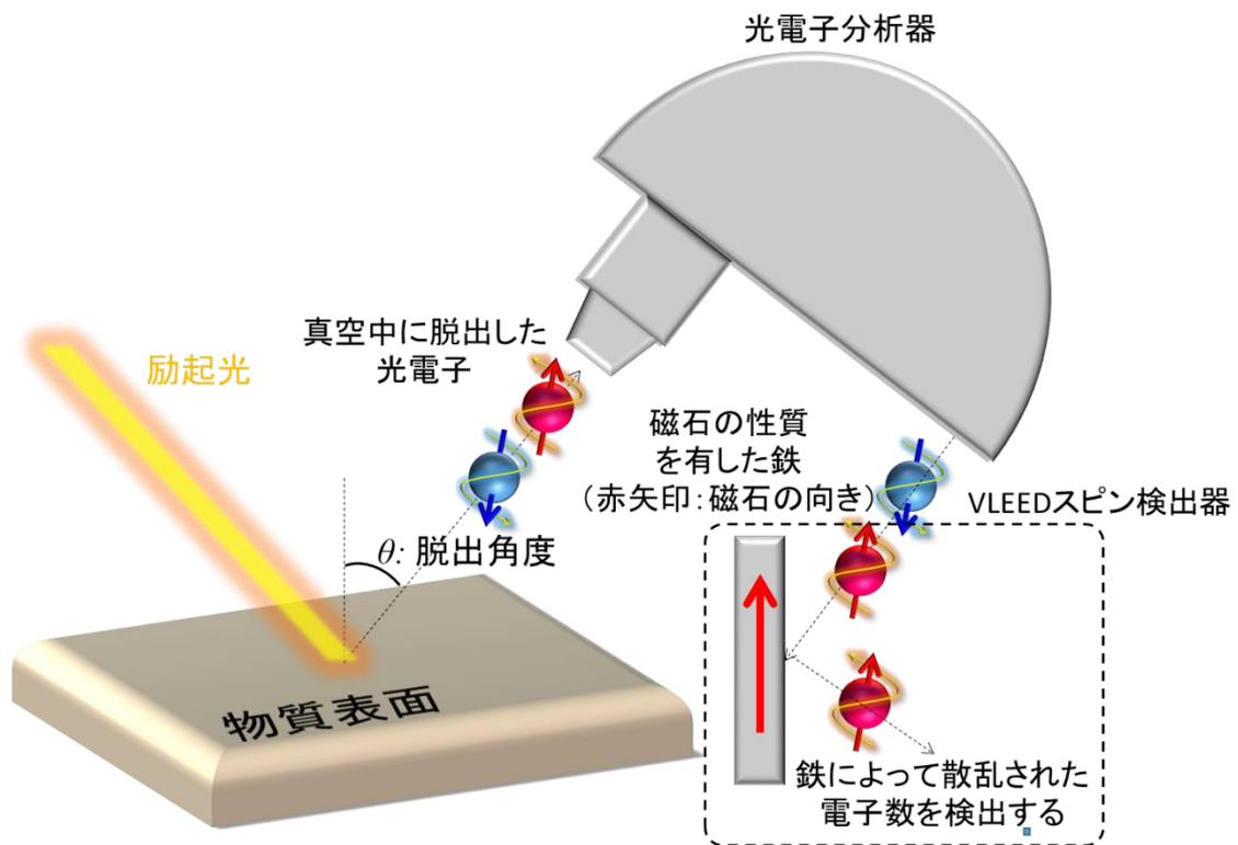
図2 スピン分解・角度分解光電子分光法の概念図
