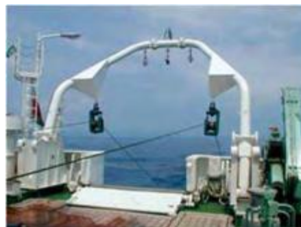
起倒式 A フレーム及び起倒式ランプドア / A-frame and Ramp door for survey
