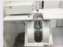
図1 生体試料中のラジカルを測定するための電子スピン共鳴吸収(ESR/EPR)測定装置(日本電子 JES FA-100)。
