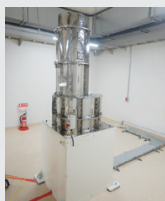
低線量率 ガンマ線照射装置 0.002~1.5mGy/min
