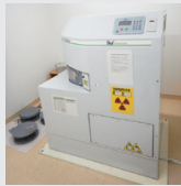
高線量率 ガンマ線照射装置 (ガンマセル)1Gy/min
