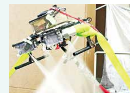
流体噴射で浮上する索状ロボット先端部分
