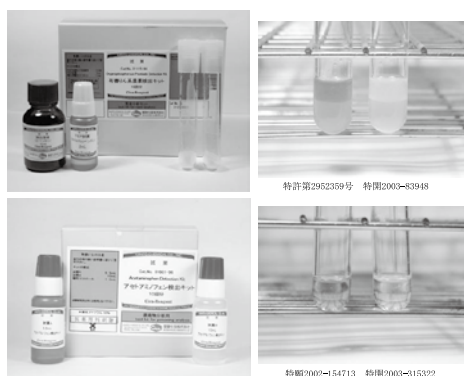
図2 検出キットと反応結果 有機リン系農薬検出キット (上) アセトアミノフェン検出キット (下)
