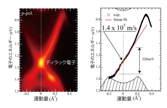
相関電子系であるタングステン表面の電子において、運動量とエネルギーとの関係が直線的な関係をもつ、質量ゼロの電子であることをはじめて観測した。また、この電子が相関電子系(通常  $2X10^4 \text{ m/s}$ )にも関わらず 1 秒間に  $10^5 \text{m}$  も移動できる事を突き止めました。
