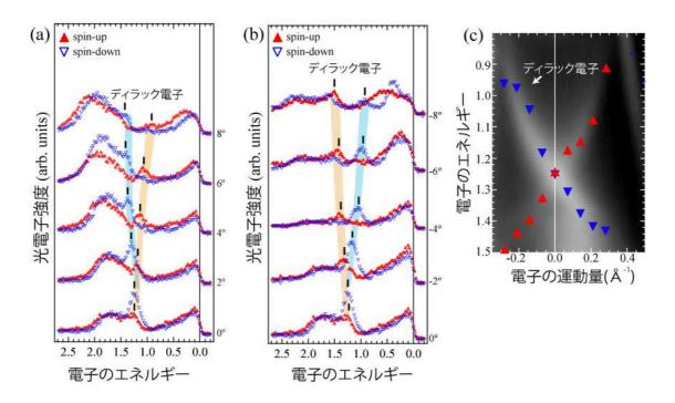
スピン角度分解光電子分光測定により、それぞれ電子の運動量を変化させながらスピン電子構造を観測した結果を(a),(b)図に示す。(青色:ダウンスピン、赤色:アップスピン)
