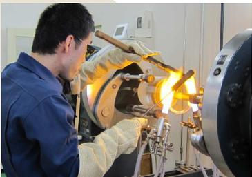
デューワー瓶の製作：大型ガラス旋盤
