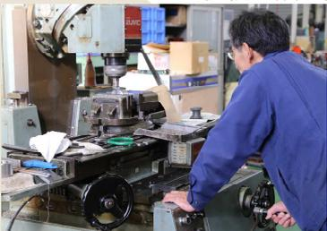
金属製品部品の切削：フライス盤
