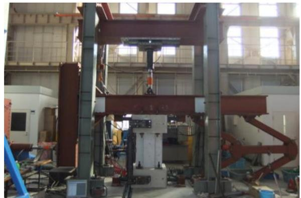
図 6.多目的載荷装置
