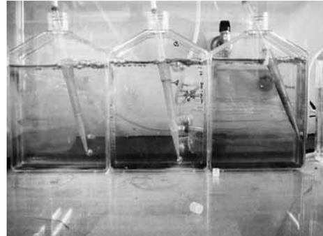
図11 エアレーション式 A（浮遊細胞培養用1 フラスコ縦置き）IWAKI 225cm<sup>2</sup>/non-treated flask（1143-225）をリサイクルして使用
