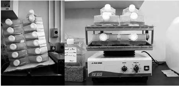
図13 震盪式（左：シーソー震盪，右：波動式）
