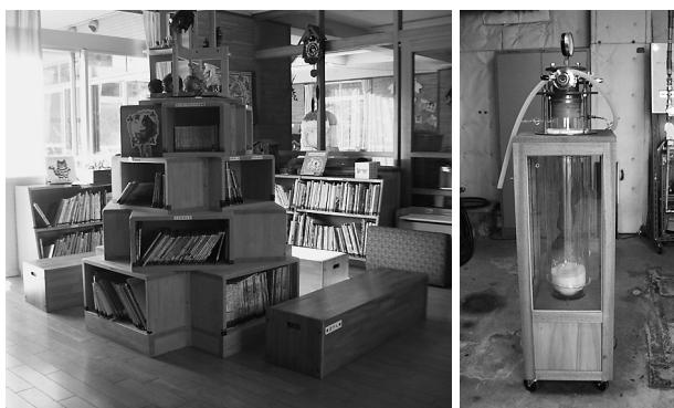
上の写真は、付属幼稚園からの製作依頼を受け製作した本棚と低温実験部から製作を依頼されて製作した超流動実験装置、外枠を木材加工室で製作し内側のデュワービンをガラス加工室で製作した製品。
