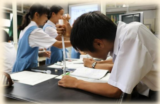
メスシリンダーで物体の体積を測定する。
