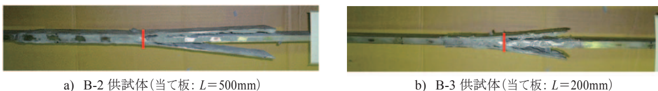
図 10. 供試体での当て板のはく離
