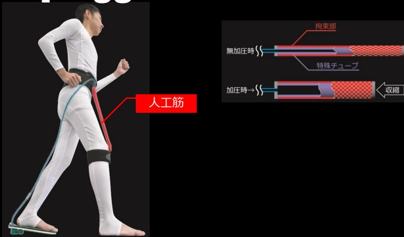
しかし、従来の空気圧人工筋は、人の運動を支援する十分な収縮力を出すためにかさばるコンプレッサやタンクを必要とした。
