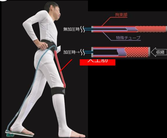
空気圧人工筋は、圧縮空気を供給することで全長が収縮する基本構造をもち、軽量柔軟であるという特徴から、身体に装着して動作を支援するアクチュエータとして適している。
