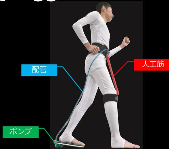
駆動部である空気圧人工筋、人工筋のための空圧源であるポンプ、伝達部である配管の3部から構成される。
