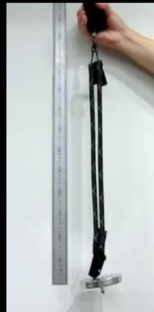
この新型人工筋は、手動ポンプ程度の低い圧力供給でも収縮し、支援力の生成が可能である。
