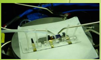
14: 測定装置にセットした流路つきバイオセンサー
