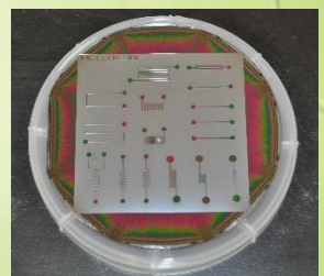
10: 4インチSiウェハに作製した流路鑄型
