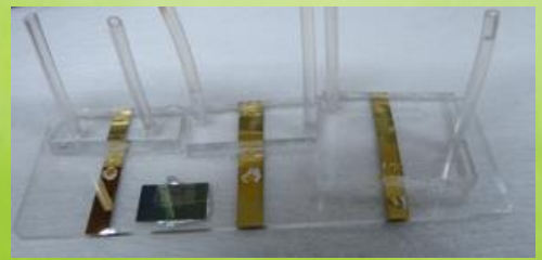
12: PDMS流路とMOSFETチップをAu電極付きガラス基板に貼合せた例
