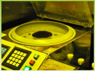
5: スピンコーターによるレジスト塗布
