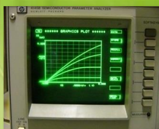
16: MOSFET電気特性の例
