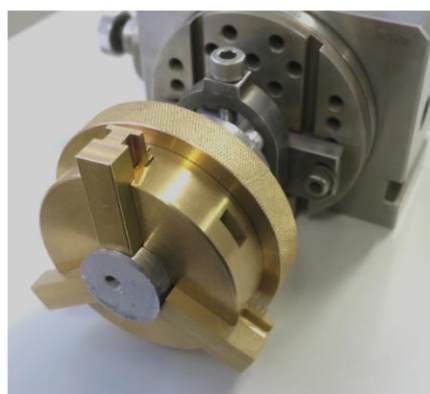
図7 割出盤に取り付けたスクロールチャック
