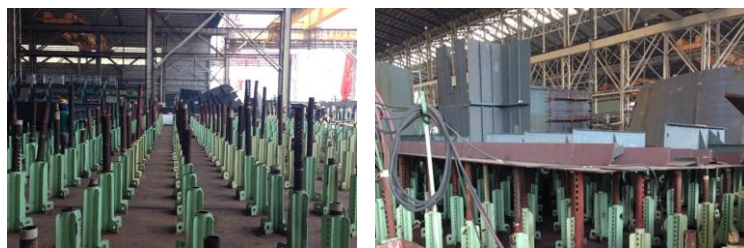
Fig. 1 ジグに支えられているプレートの様子(左)と現場にあるジグ(右)
