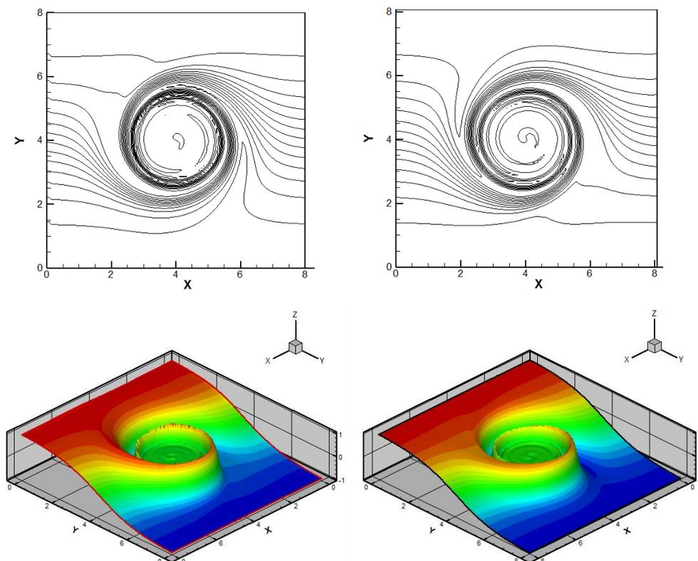
図 6. 二次元移流シミュレーション結果 WENO scheme(左) CIP(右)
