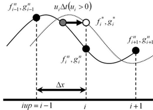
図 3. CIP 法の概要図
