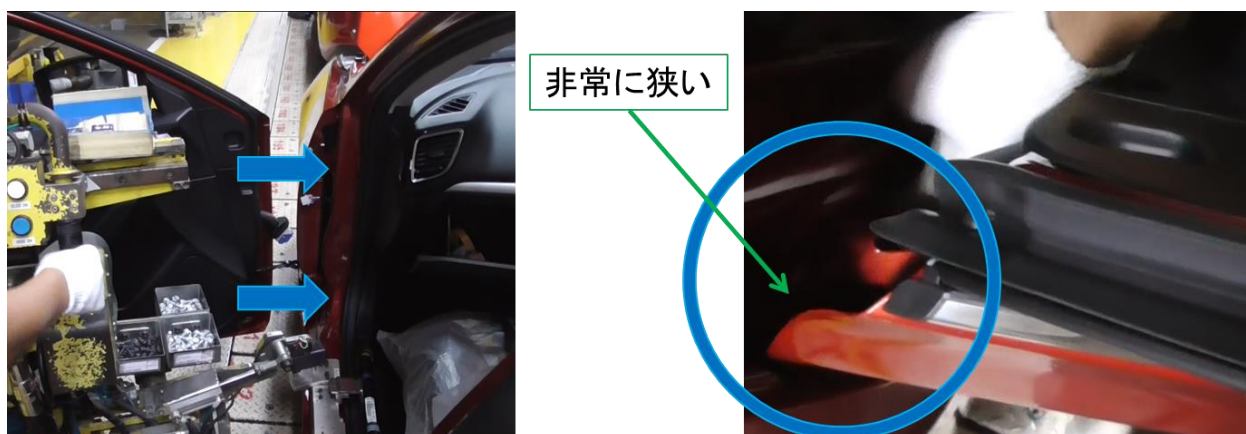
Fig. 4 ドアの取り付け作業
