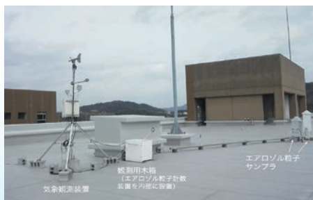
写真1 総合科学部A棟屋上に設置された大気観測装置群
